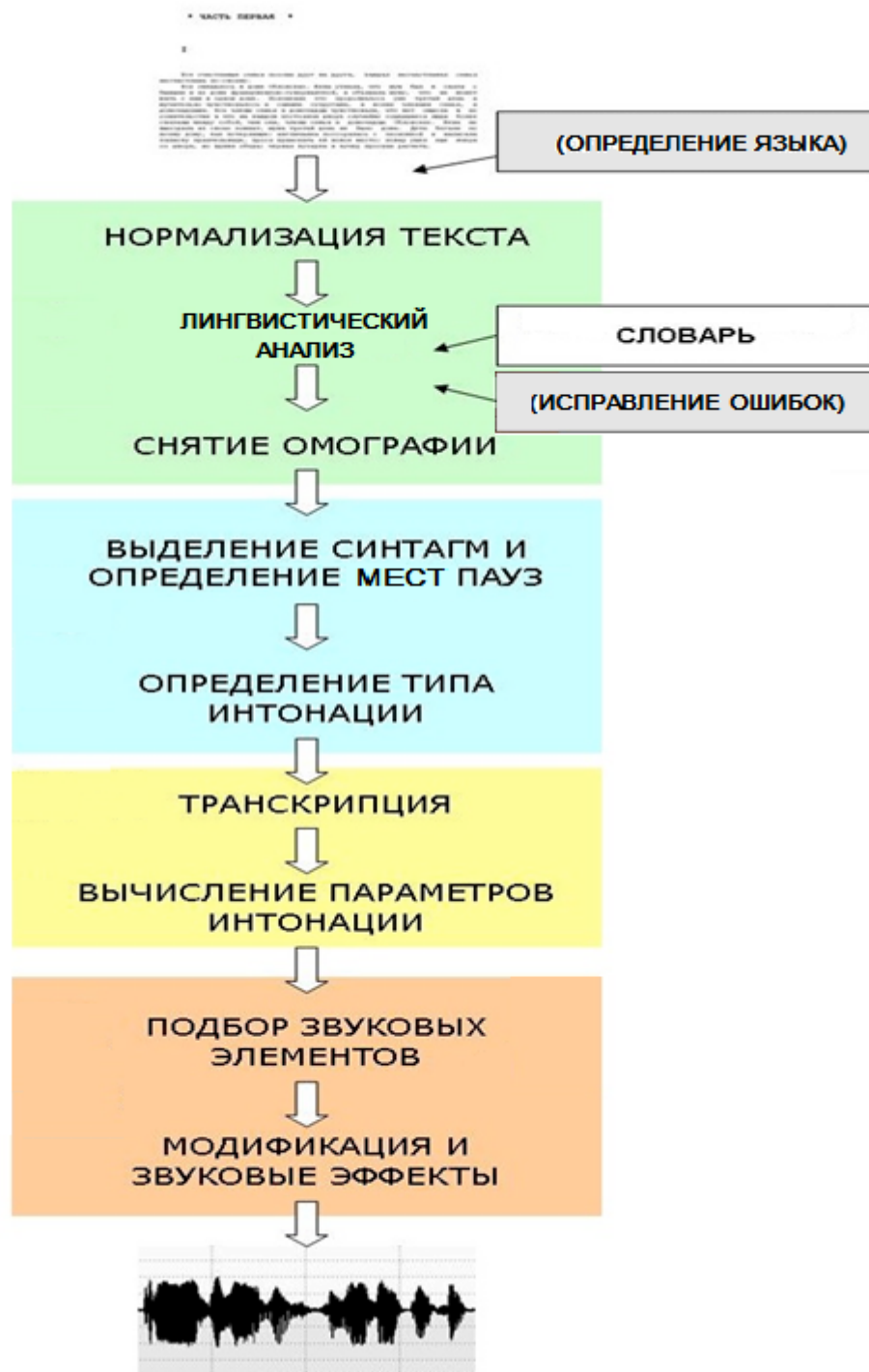
Рис. 15. Общая структура селективного синтезатора речи
