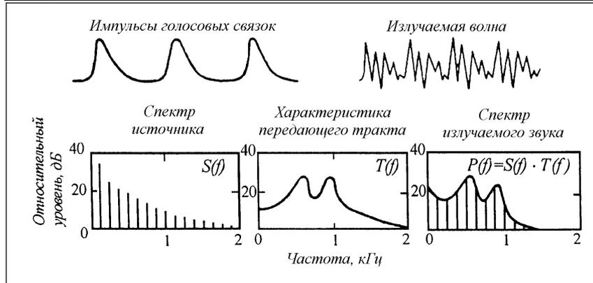
Рисунок 21. Схема образования звука с голосовым источником.
