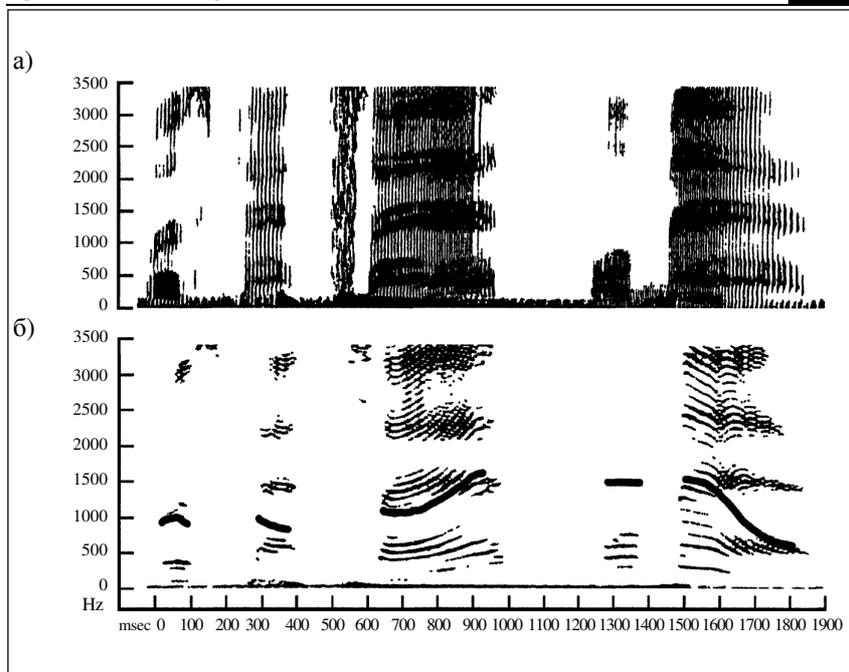
Рисунок 23. Широкополосная (а) и узкополосная (б) спектрограммы.
