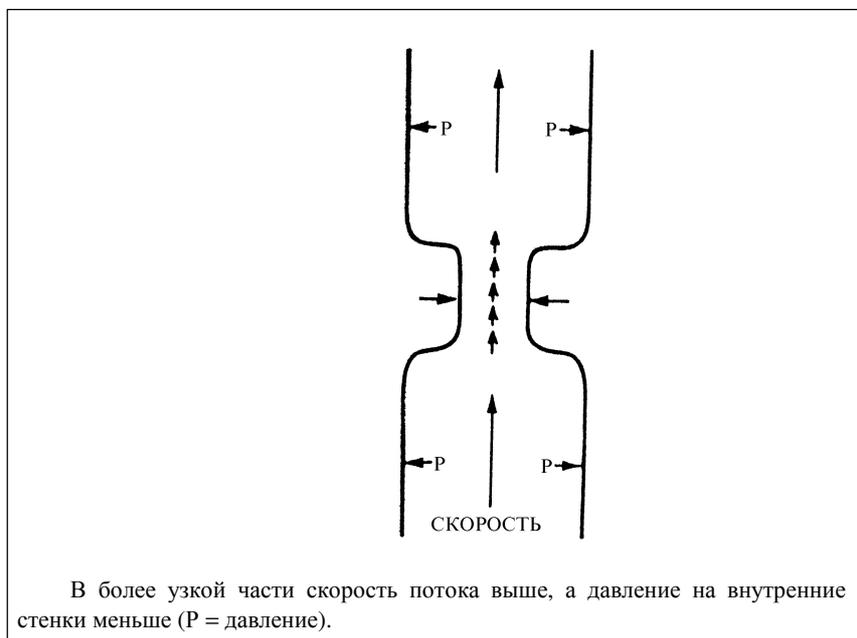
В более узкой части скорость потока выше, а давление на внутренние стенки меньше (P = давление).
