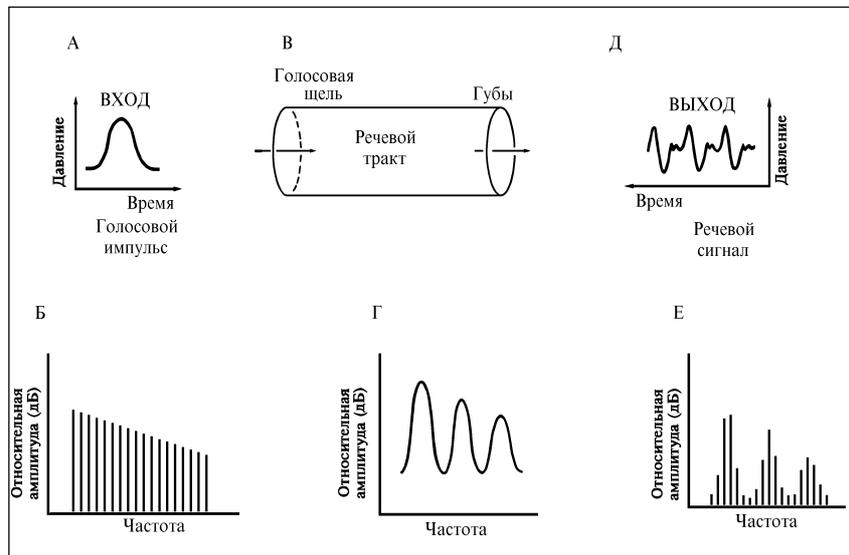
Рисунок 22. Схема образования речевого сигнала при производстве гласного.
