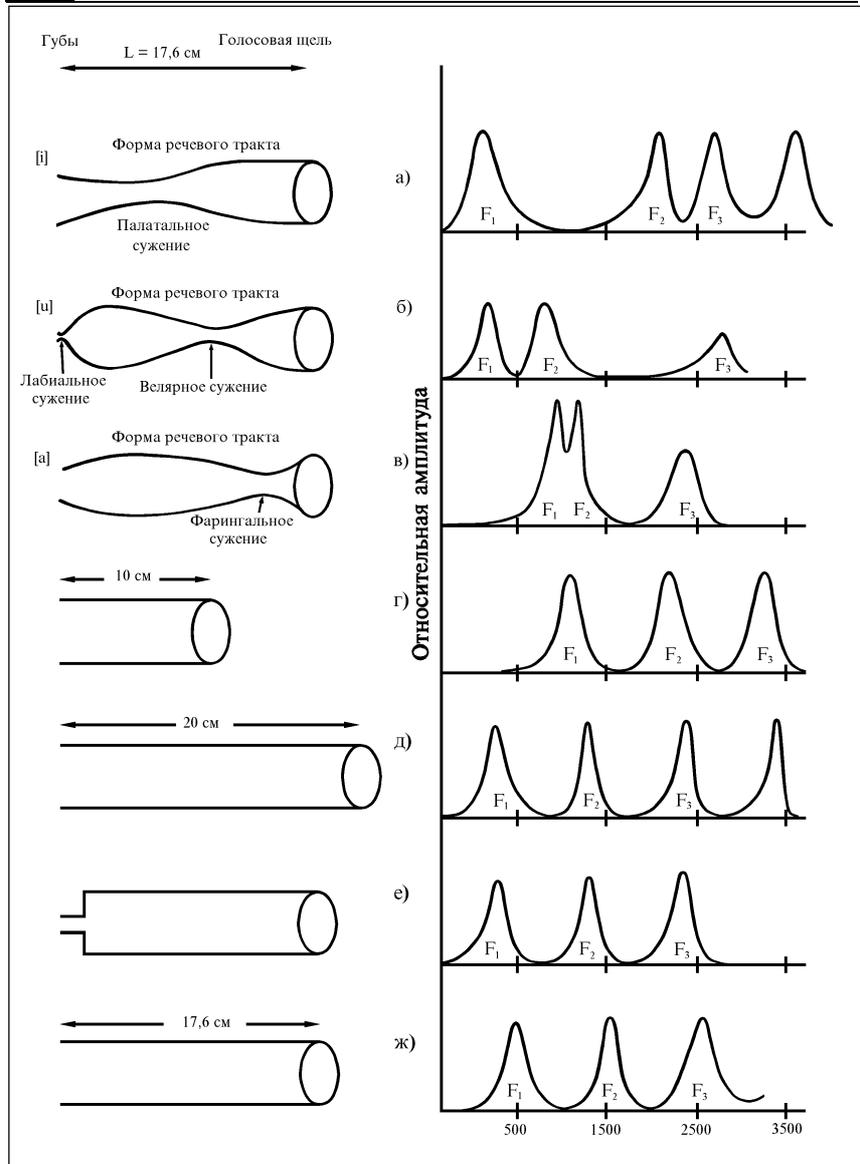
Рисунок 33. Влияние формы тракта на его резонансные свойства.
