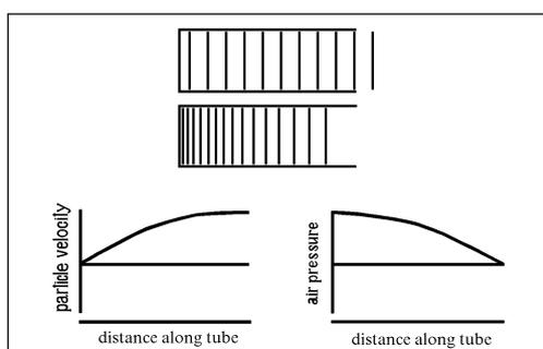
Рисунок 25. Воздух в трубке, вибрирующий как пружина (вверху).
